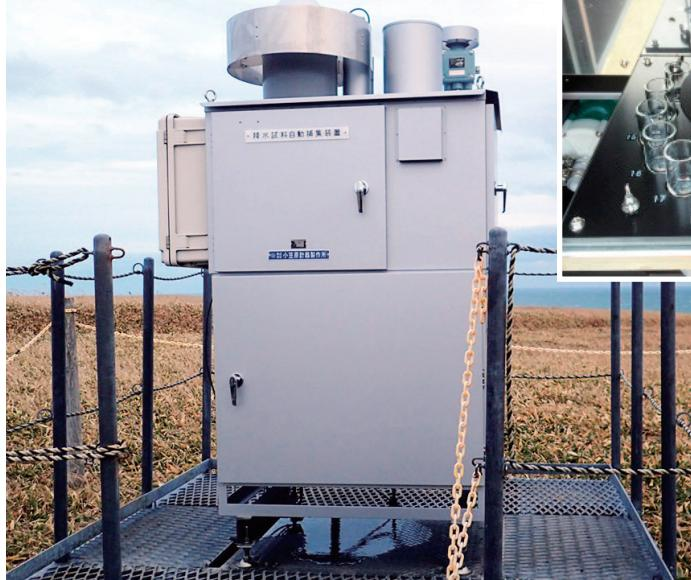
US-421降水試料自動捕集装置 捕集装置内部
