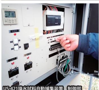
US-421降水試料自動捕集装置 制御部
