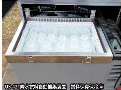
US-421降水試料自動捕集装置 試料保存保冷庫
