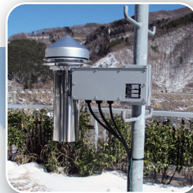
強制通風式 一体型温度湿度計
