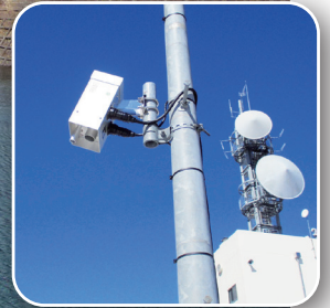
レーザー式積雪深計(人体検知センサー付)
