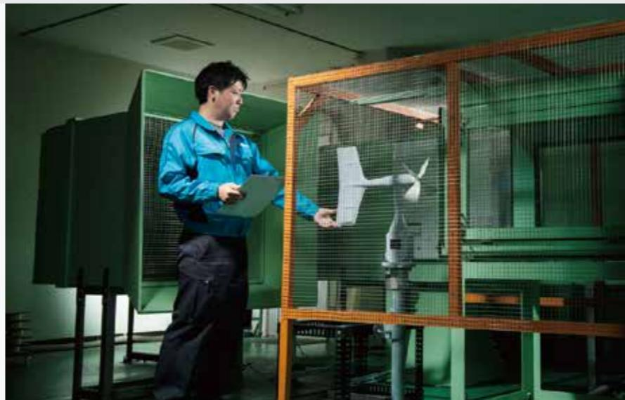
ANEOSでは、国内気象器メーカーの中で最大規模の風洞施設(最大風速40m/s)の他、気象庁保有の器差測定設備と同等精度の設備を有しております、あらゆる試験を自社で行える体制が整っています。これにより風車型風速計、風杯型風速計、転倒ます型雨量計、電気式温度計、電気式湿度計、電気式気圧計、積雪計の7区分については、「認定測定者」として、気象測器の検定のための器差測定が行えるようになっています。ANEOSが発行する測定結果報告書を添えて申請することで気象測器の検定を取得できます。こうした社内検査設備の充実は、高品質な製品を確実にお客様へご提供したいという、私たちの思いのあらわれです。
