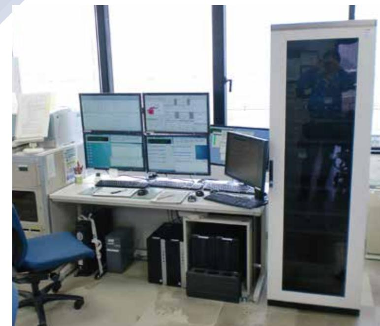
航空気象観測システムは、航空機の離着陸に重要な風向風速の観測だけなく、雲の高さや滑走路上の視程(RVR)、気温、湿度、雨量、気圧などの観測を行い、関連するシステムや関係機関へ気象データの通報を行います。
