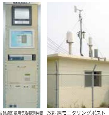
放射線監視用気象観測装置 放射線モニタリングポスト 酸性雨自動分析装置
